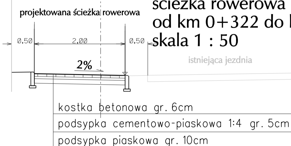
PRZEKRÓJ NORMALNY ścieżka rowerowa w granicach pasa drogowego od km 0+444 do km 1+170 skala 1 : 50
